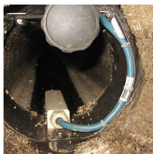
Măsurarea apă-ultrasunete și hidrostatică - pentru detectarea intervalelor de refulare din mediu De ex., măsurarea refulării din precipitații.
