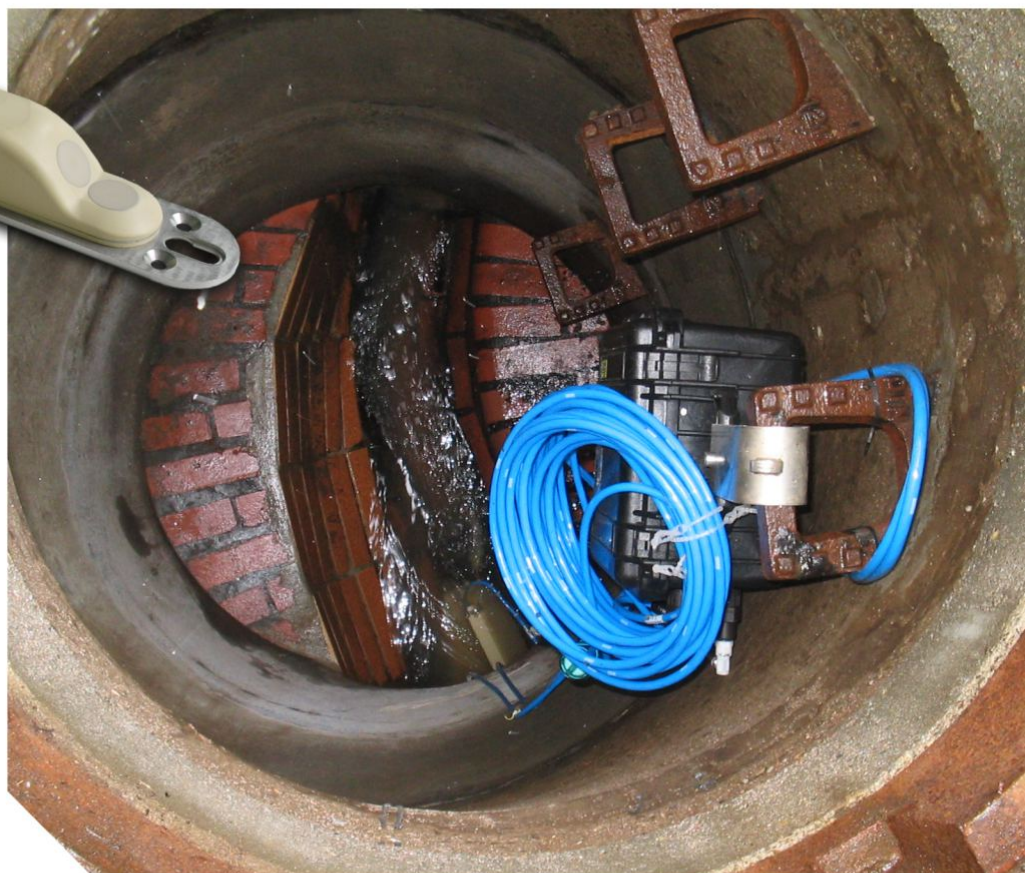
Senzor de conductă pentru instalare în conducte și în NIVUS Pipe Profiler
