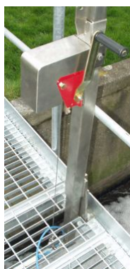
Mecanism de ridicare în scopul de verificare sau de înlocuire a senzorului
