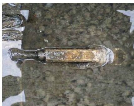
Senzorul de tip pană funcționează bine în ciuda depunerilor.
