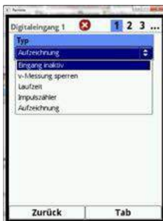
Fig. 7-61 Activarea intrării digitale
