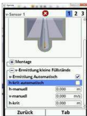
Fig. 7-45 Meniul pentru calcularea v/h
