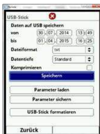
Fig. 7-126 Comandă de stocare a datelor de măsurare
