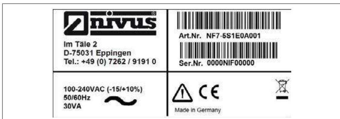
Fig. 3-3 Plăcuța de identificare versiunea AC
