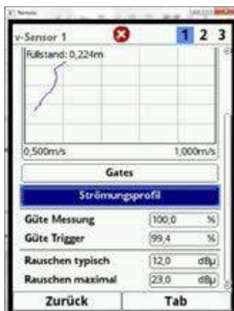
Fig. 7-84 Selectarea profilului de debite in 3D
