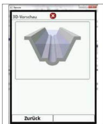
Fig. 7-15 Trapez cu canal de vreme uscată
