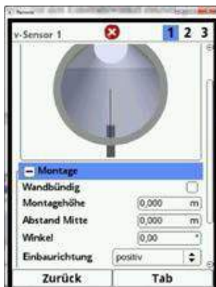
Fig. 7-35 Programarea valorilor: înălțimea, distanța și unghiul
