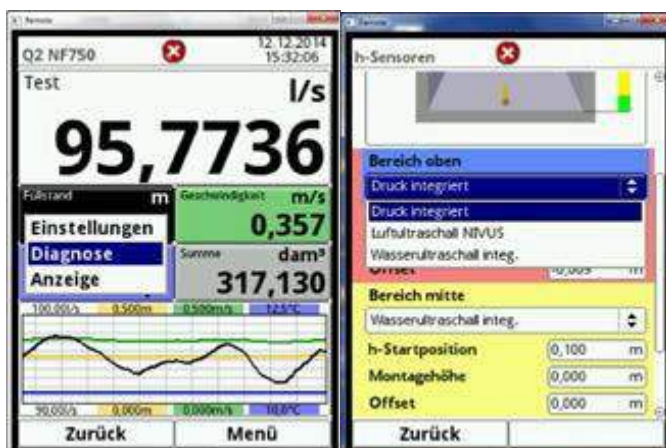
Fig. 8-11 Selectarea directă a posibilitatilor de diagnosticare al senzorilor de nivel individuale
