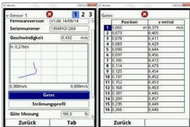
Fig. 8-18 Tabel cu viteze individuale măsurate
