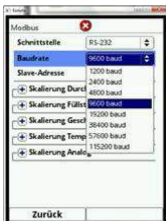
Fig. 7-159 Setare Viteza de transmisie
