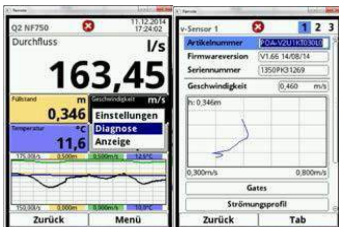
Fig. 8-17 Informații despre senzor viteză de curgere
