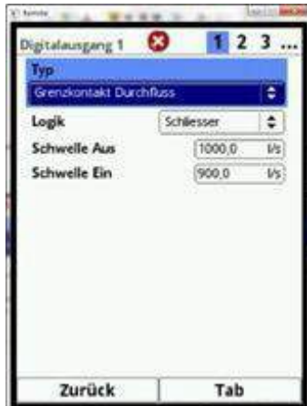
Fig. 7-66 Programare contactului de limită
