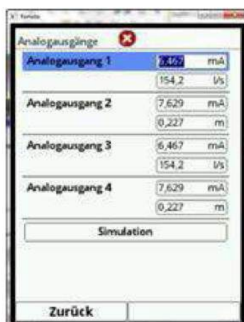
Fig. 7-90 Afișaj valori de ieșiri analogice
