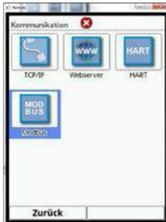
Fig. 7-157 Selectarea de programare Modbus
