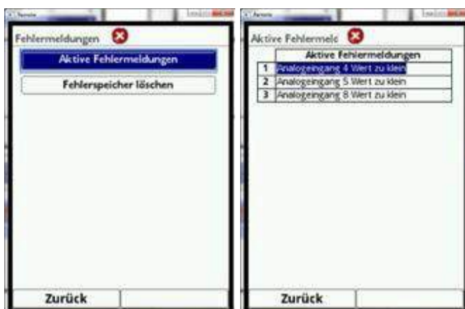
Fig. 7-146 Afișarea mesajelor de eroare curente
