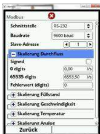
Fig. 7-161 Programare, scalare valori de măsurare
