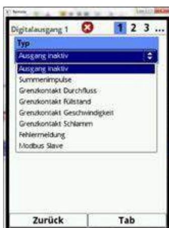
Fig. 7-64 Activarea ieșirilor digitale
