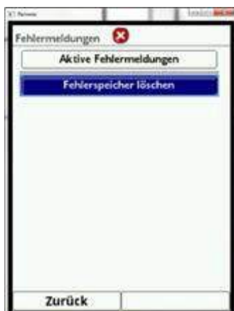
Fig. 7-147 Stergerea mesajelor de eroare curente
