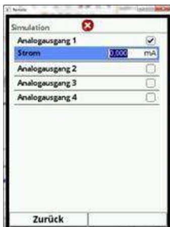
Fig. 7-94 Programarea valorii debitului simulat dorit
