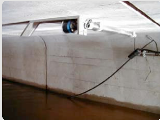
Măsurare de nivel ultrasonică cu oglindă înclinată
